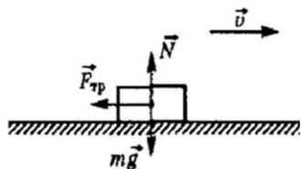
2)  $F_{\text{упр}} = F_{\text{тр}}$  (при равномерном движении);
